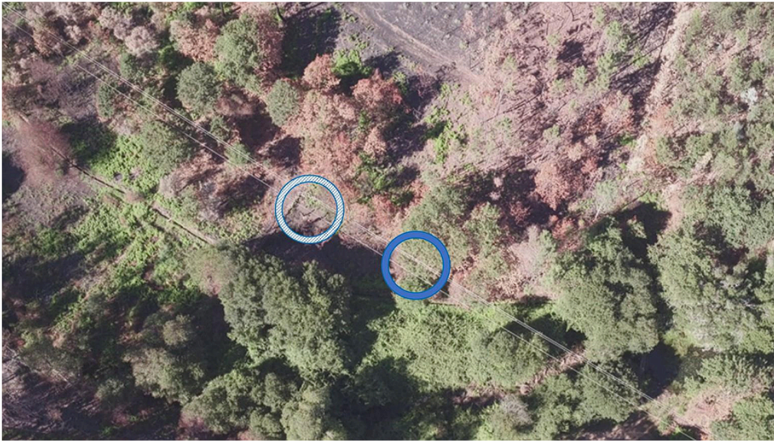
Figura 115 – Vista obtida com um drone do mesmo local, indicando o local de contacto (circunferência a tracejado). Está igualmente assinalado o ponto indicado como tendo sido o local de origem do incêndio (circunferência a cheio).
