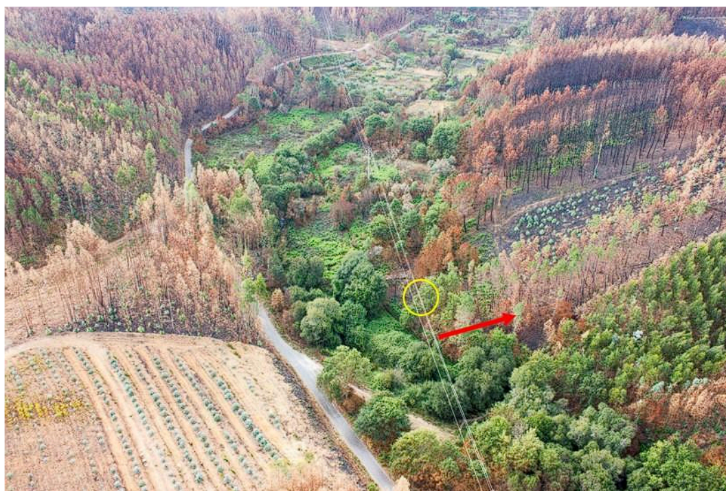
Figura 114 – Vista aérea do local de início do incêndio de EF. A circunferência amarela assinala o ponto de contacto provável entre a linha elétrica e a vegetação. A seta indica o sentido da propagação, no chão, para a encosta.
