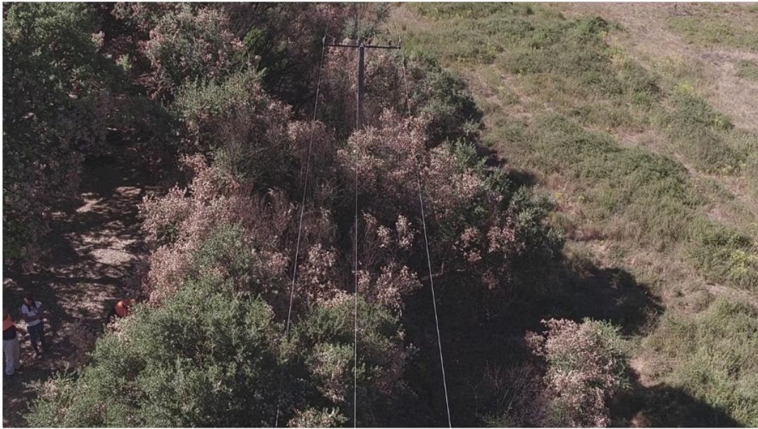
Figura 117 – Imagem recolhida por um drone dos sobreiros na zona em que existe uma grande proximidade entre a linha e a ramagem e debaixo da qual se terá iniciado o incêndio de Regadas.
