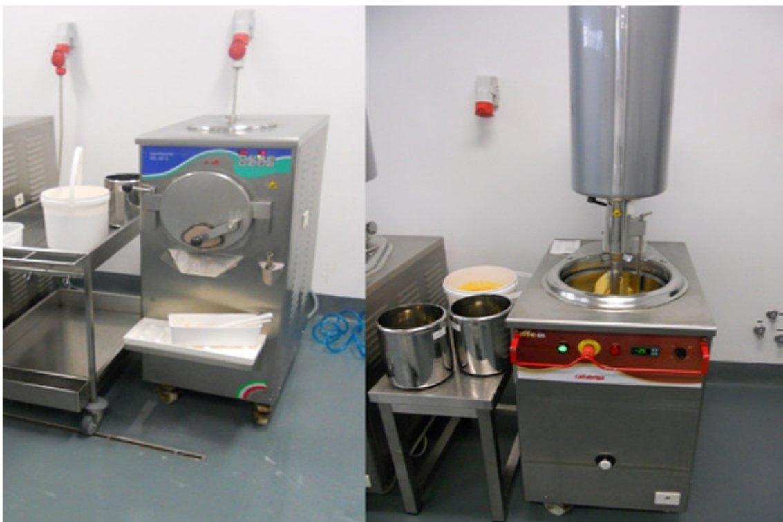
Figura 3 – Máquinas de abaixamento de temperatura. À esquerda centrifugadora de abaixamento de temperatura. À direita máquina vertical de abaixamento da temperatura
