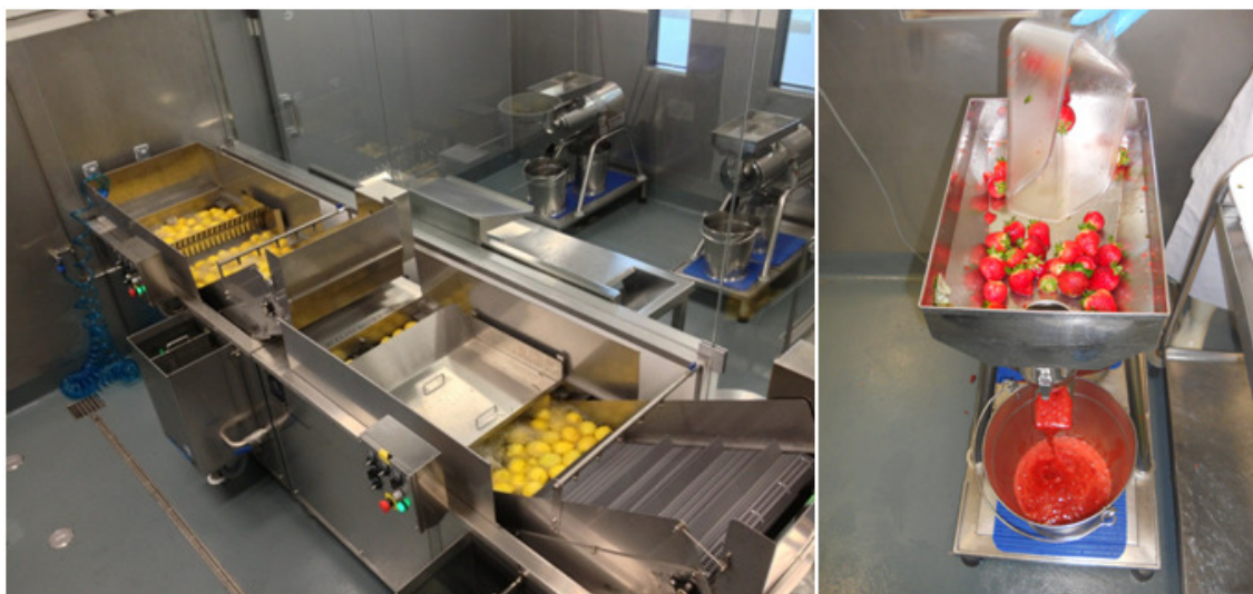
Figura 2 – Máquinas utilizadas na 1ª fase do processo. À esquerda máquina de lavagem de fruta, e bancada de descasque da fruta. À direita máquina de extração de polpa da fruta
