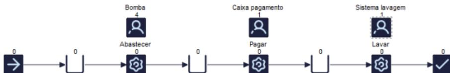
**Figura 2:** Sistema da bomba de combustível no Simul8.
