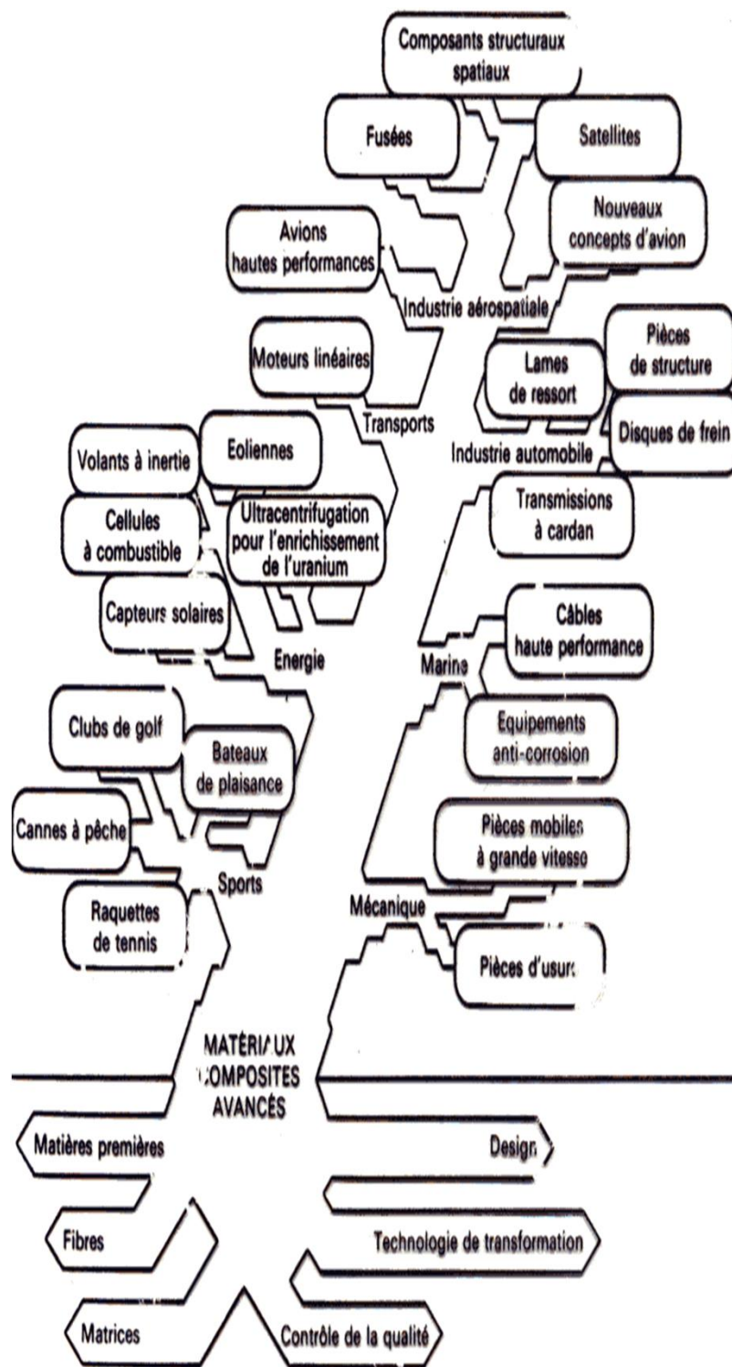
Figure 6.3. Toray : Diversité des applications des matériaux (Source : Toray cité par le GEST.)
