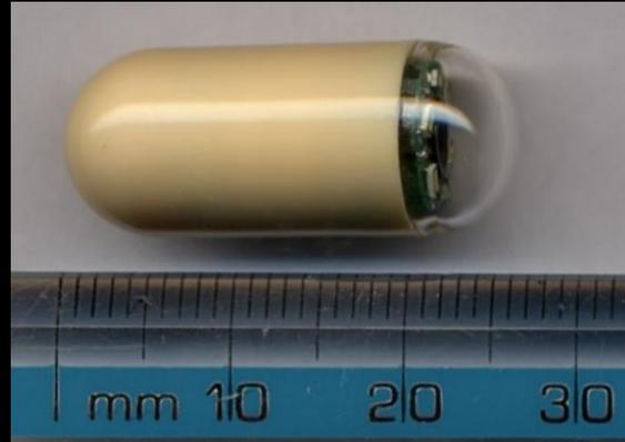
O procedimento traduz-se no simples ato de engolir um robô do tamanho de um comprimido, que percorre o tubo digestivo para recolher dados e tirar fotos que podem ser diretamente enviadas para um processador, para realizar diagnósticos.
