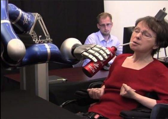
Braço robotizado que replica suavemente os movimentos de um cursor num ecrã, controlado pela atividade cerebral de uma pessoa sentada perto do robô, com um chapéu coberto de elétrodos.
